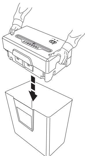
**DE** Maschine in den Auffangbehälter setzen.
